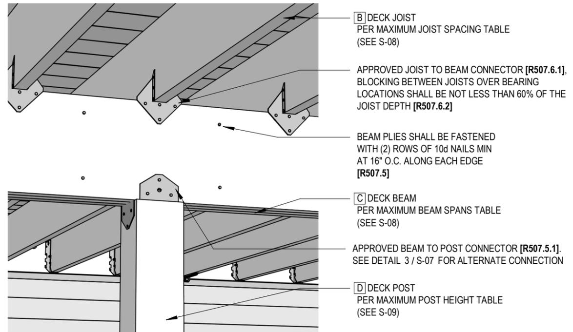
**2 JOIST TO BEAM AND BEAM TO JOIST CONNECTION**
